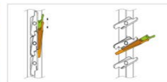
Leva premontata con dispositivo di blocco ed orientamento graduale delle lamelle.
